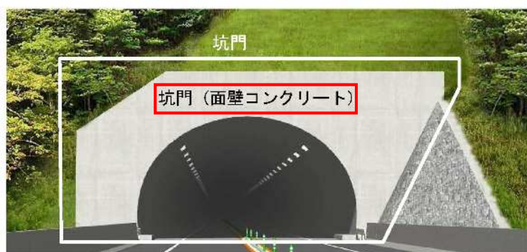
図3.1 トンネル本体工点検箇所
