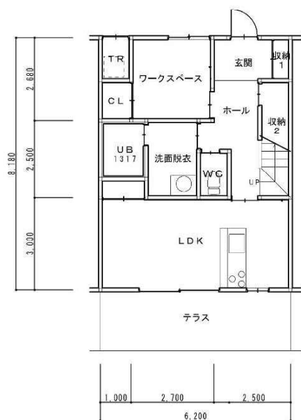
Bタイプ1階平面図 1 : 1 0 0
