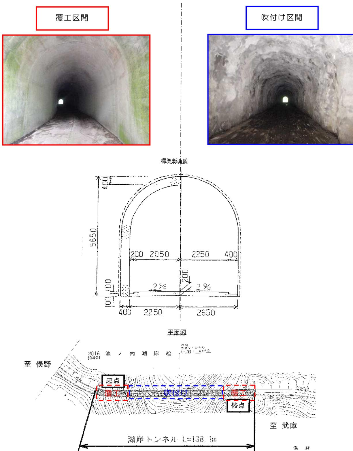
図 2.1 湖岸トンネルの坑内構成
