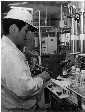
無菌室でボトルにキャップを取り付ける作業員④
